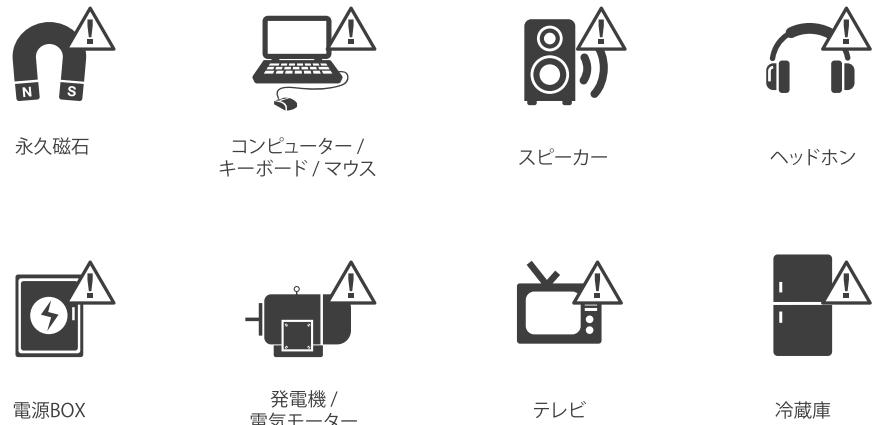
Perception Neuronシステムは、強い磁気干渉を伴う環境では使用しないでください。このような環境でシステムを使用すると、モーションキャプチャの結果に重大なエラーが発生します。このような環境に長時間センサをさらすと、センサーの磁化が発生します。
