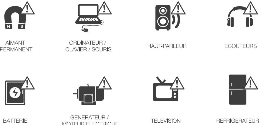
Le Perception Neuron PRO ne doit pas être utilisé dans un environnement avec des interférences magnétiques fortes. L'utilisation du système dans un tel environnement présente des erreurs significatives aux résultats de capture de mouvement. L'exposition de capteurs à un tel environnement pendant longtemps causera la magnétisation de capteur dans un mauvais référentiel.
