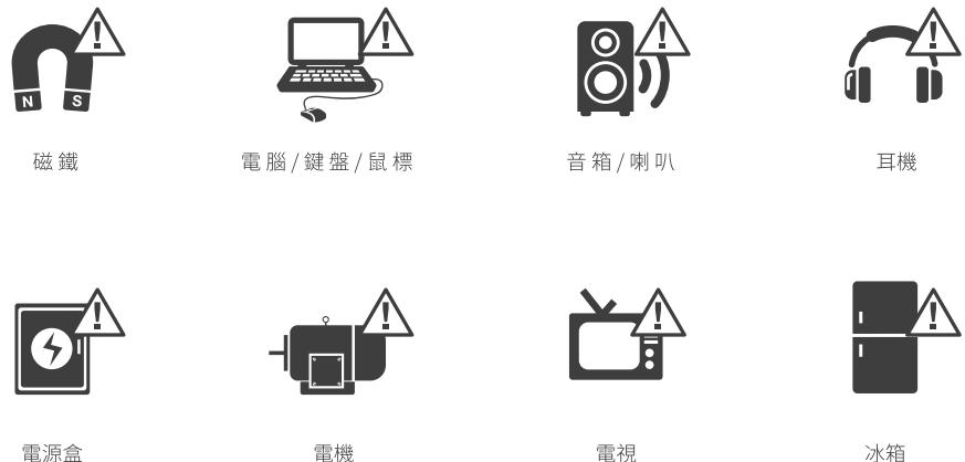
Perception Neuron PRO會被環境中的強磁場幹擾，造成數據錯誤影響動作捕捉效果，同時如果 Neuron傳感器長時間暴露在磁場中可能會造成傳感器磁化。
